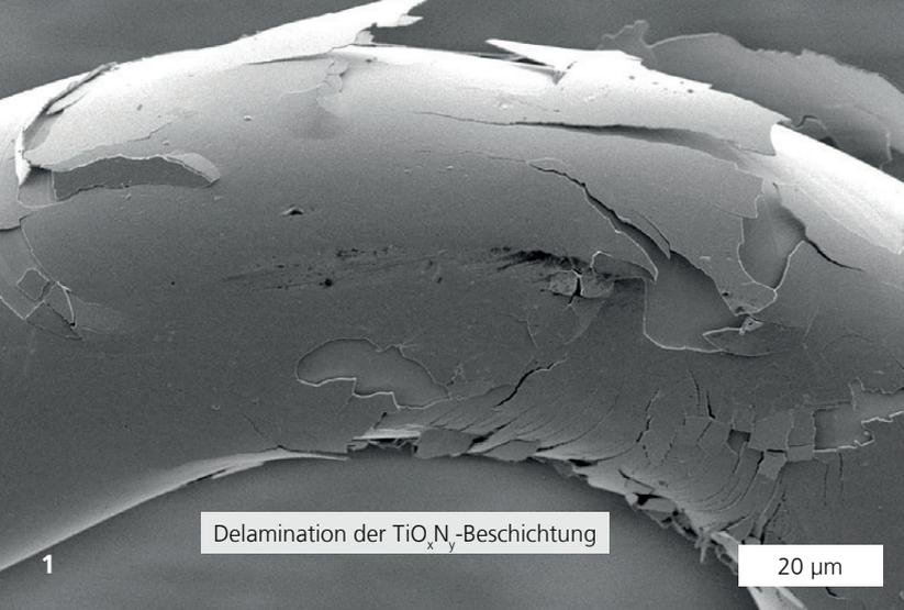
Delamination der  $TiO_xN_y$ -Beschichtung
